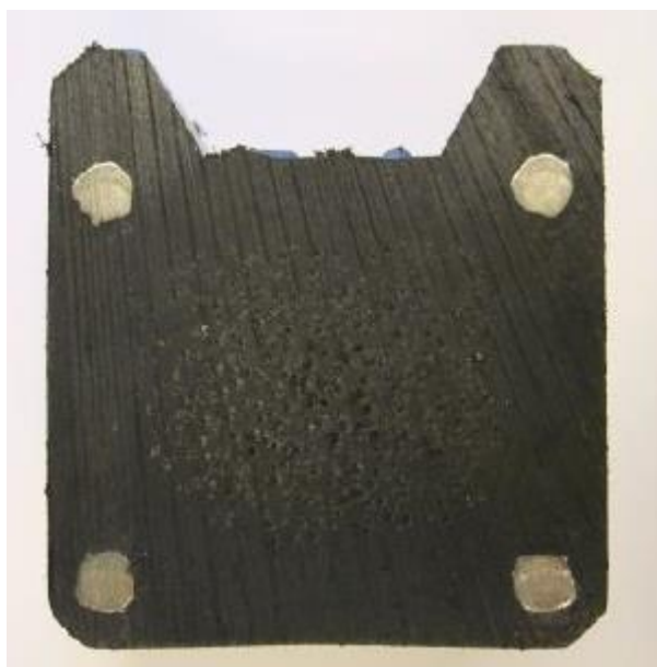
Figuur 3 - Doorsnede staalversterkte gording
