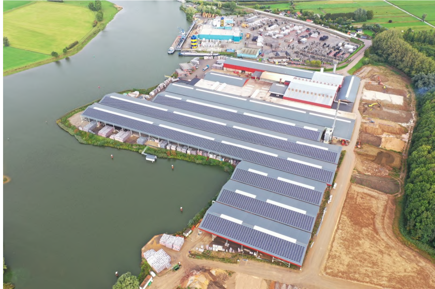
Overkapt tasveld met 12500 m2 PV panelen 7140 stuks
