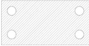
Figuur 3 - Doorsnede staalversterkte ligger
