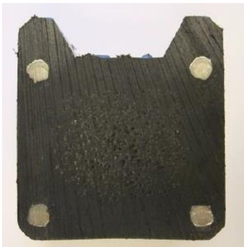
Figuur 4 - Doorsnede staalversterkte gording
