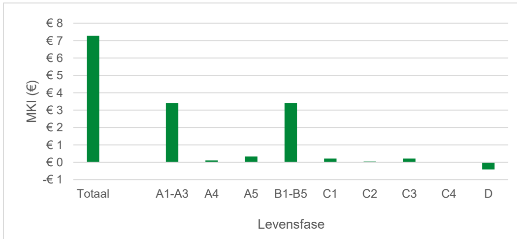
MKI per levensfase van 1 meter Geleiderails, gerenoveerd, verzinkt staal, type VLP 2Z 133-80
