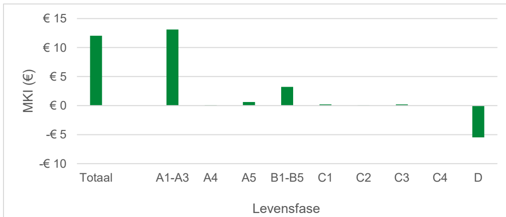
MKI per levensfase van 1 meter Geleiderails, nieuw, verzinkt staal, type VLP 1Z 133-60
