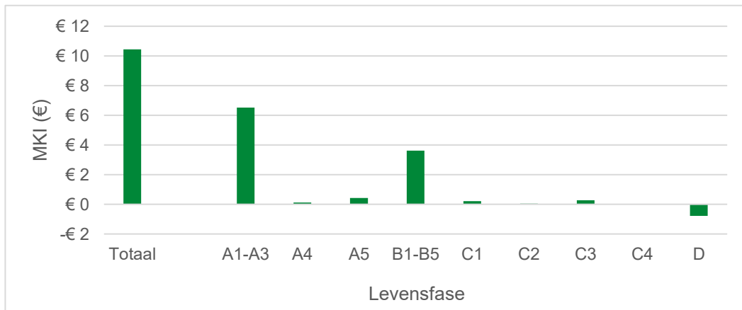
MKI per levensfase van 1 meter Geleiderails, gerenoveerd, verzinkt staal, type VLP2DL 133-80
