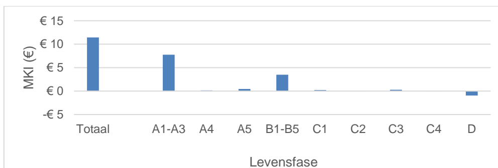
Figuur 33: Zwaartepuntanalyse, MKI per levensfase van 1 meter Geleiderails, gerenoveerd, verzinkt staal, type VLP 1R 133-60
