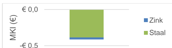
Figuur 32 Zwaartepuntanalyse, MKI per proces van module D van 1 meter Geleiderails, gerenoveerd, verzinkt staal, type VLP 1Z 133-60
