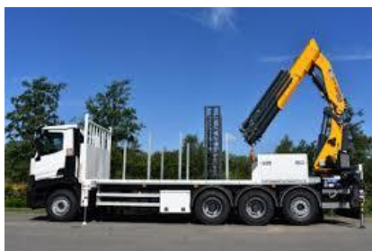
vrachtwagen met kraan voor het transport en de montage van de stijlen en de panelen.
