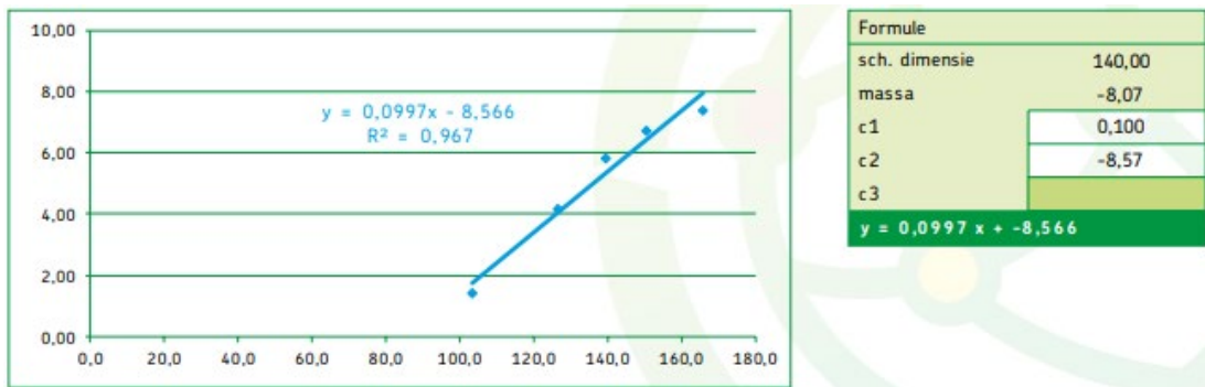
Figuur 3-6: Schaling op basis lineaire functie
